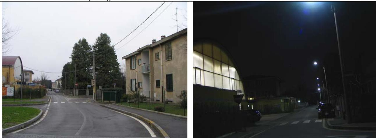
*Fig. 7.4 – Via Carducci. La visione notturna evidenzia lo stato di sotto illuminazione causato dalle inefficienti sorgenti ai vapori di mercurio.*
